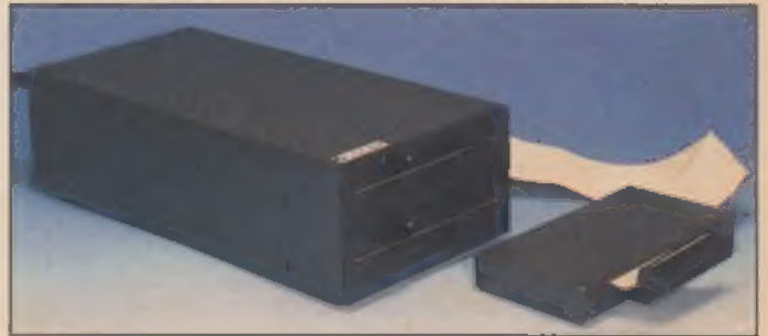
Bild 2. Mehr als 700 KByte Speicherplatz bietet das 5 1/4-Zoll-Laufwerk von Vortex
